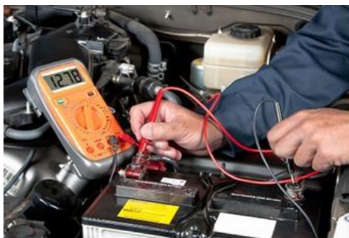
Рис. 3. Проверка напряжения аккумуляторной батареи
