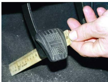
Рис. 1. Проверка свободного хода педали сцепления
