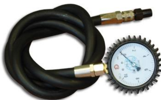
Рис. 3. Манометр для измерения давления масла в системе
