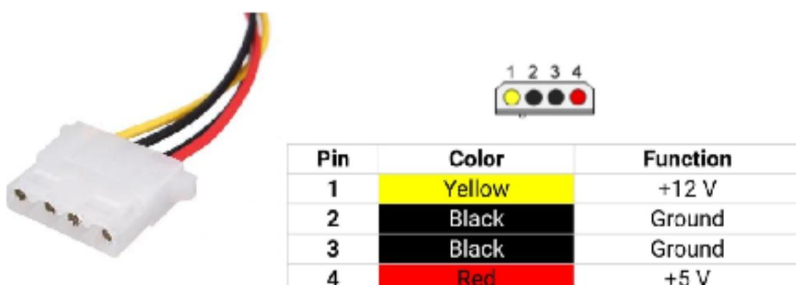
Сегодня сфера применения этого разъема сузилась до питания корпусных вентиляторов, передних панелей корпусов ПК, разветвителей и переходников питания видеокарт и накопителей. Например, переходников питания видеокарты «Molex — PCI-E 6 pin». Несмотря на то, что разъем выдает до 11 А на контакт, а значит, может дать видеокарте, в теории, 132 ватта мощности, использовать его стоит крайне осторожно.
